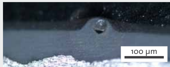
Oberflächenstörung | surface defect ohne AGA | without OGF
